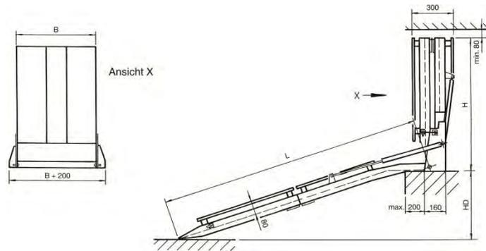
Die Rollstuhlrampe-RLK zeichnet sich besonders durch einfaches und sicheres Handling aus. Sie kann von einer Person leicht bedient werden. Durch die Verwendung von Gasdruckdämpfern ist der Kraftaufwand beim Auf- und Zuklappen angenehm gering.
