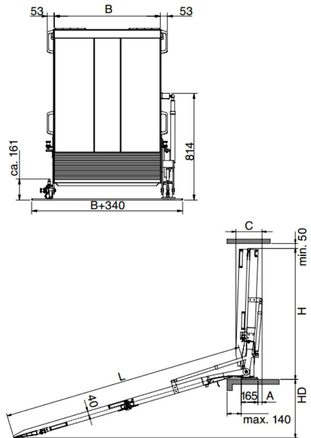
**Technische Daten drehbare Rampe Typ RRD**
