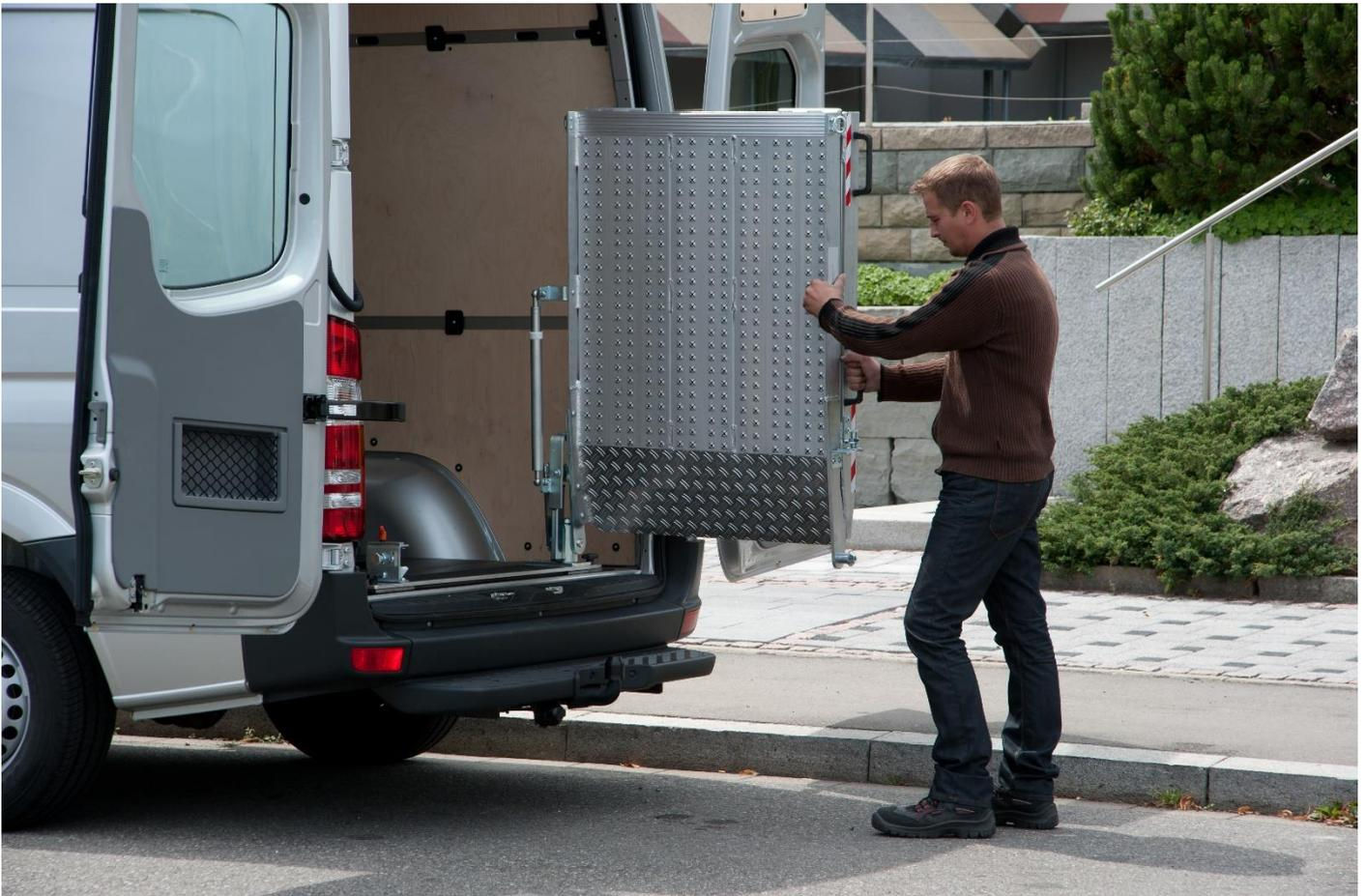
Die Einbaurampe Typ RRD zeichnet sich durch leichte Bedienbarkeit aus und vereinfacht die Abläufe beim häufigen Be- und Entladen. Gaszylinder gewährleisten einen geringen Kraftaufwand beim Bedienen. Die gelochte Fahrfläche bietet eine hohe Rutschsicherheit, durch die Lochung kann Regen, Schnee und Schmutz schnell entweichen.
