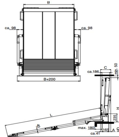
Die Einbaurampe Typ RRK zeichnet sich durch leichte Bedienbarkeit aus und beschleunigt und vereinfacht die Abläufe beim häufigen Be- und Entladen. Gaszylinder gewährleisten einen geringen Kraftaufwand beim Bedienen. Die gelochte Fahrfläche bietet eine hohe Rutschsicherheit, durch die Lochung kann Regen, Schnee und Schmutz schnell entweichen.
